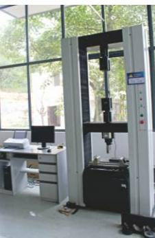
电子式万能试验机
