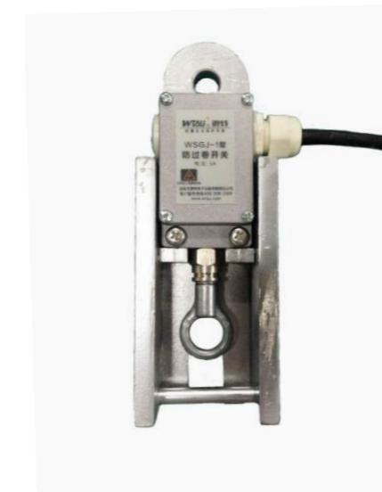
用于其重机钢丝绳防过卷的一种机械式自动保护开关,它与一适合重量的重锤配套使用,利用吊钩的上下运动托起或放下重锤时断开或接通开关,实现自动切断卷扬机动力电源,达到限制钢丝绳过卷的目的.
