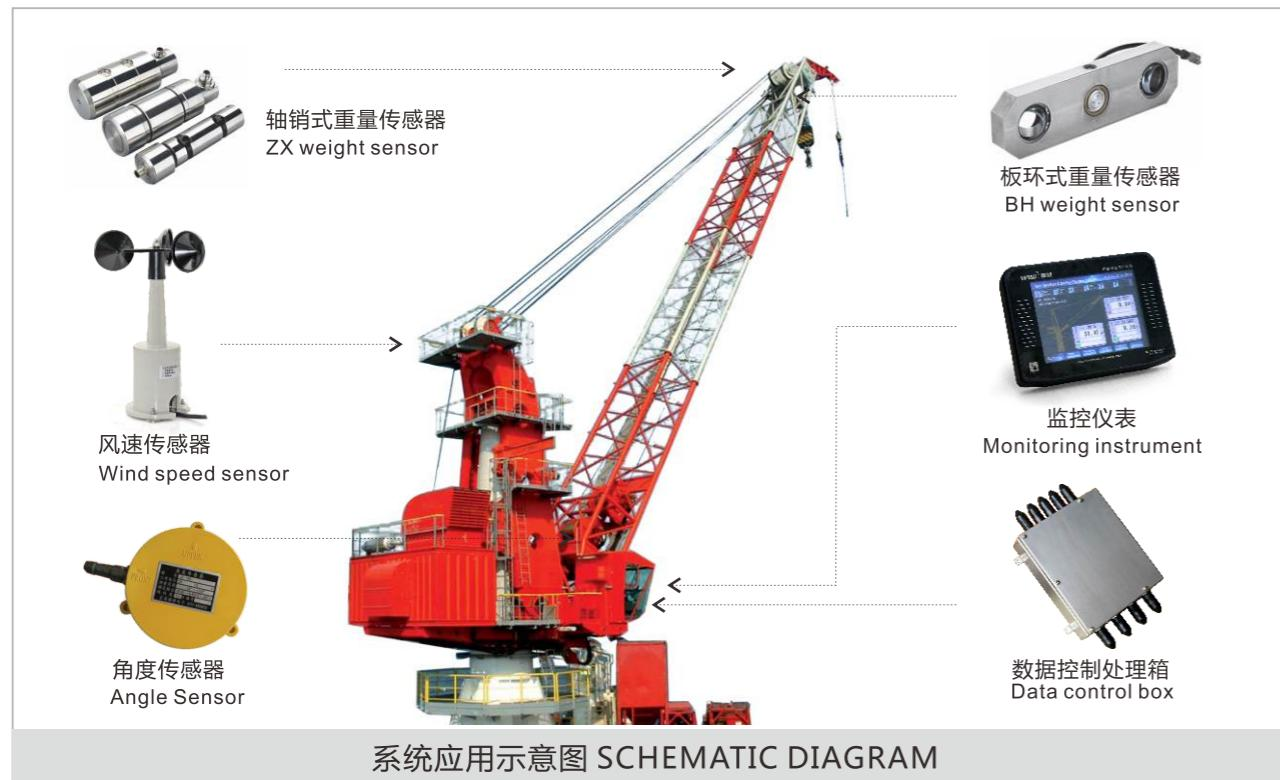
系统应用示意图 SCHEMATIC DIAGRAM
