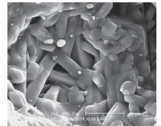
JMS-70莫来石 SEM SEM image of JMS-70 Sintered mullite
