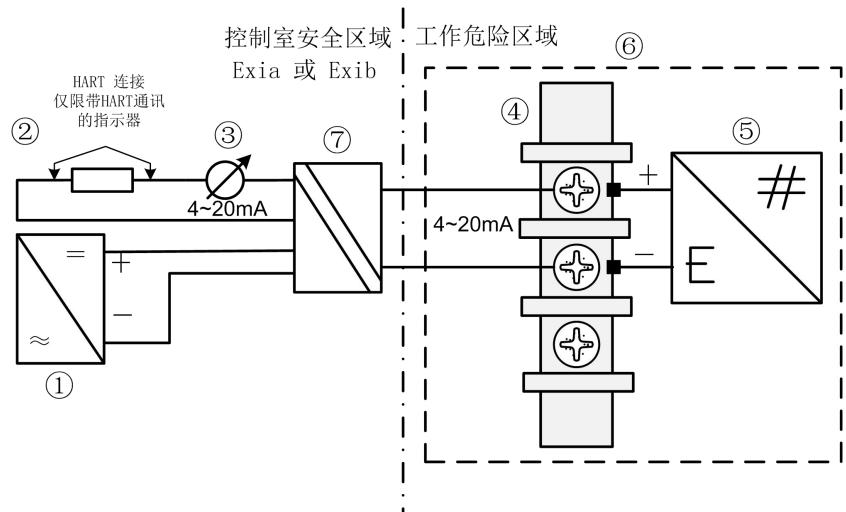
①电源，根据隔离式安全栅的型号，电源可以为 AC220V DC24V      ②外部负载，用于 HART 通讯
