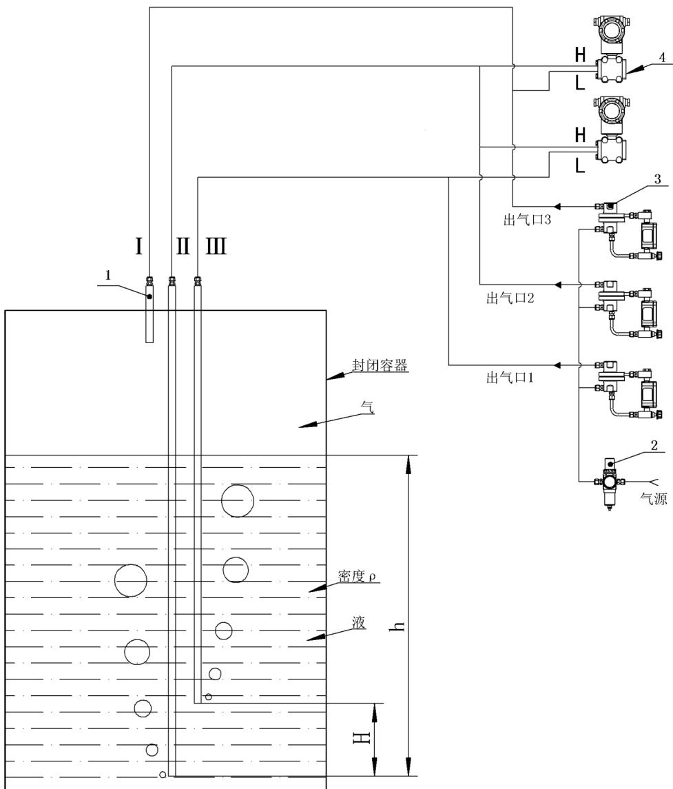
图 2-1 测量密闭容器内液位、密度等参数
