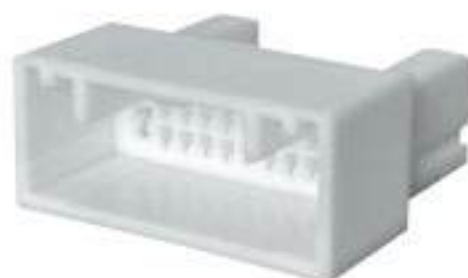
Type: TS30300-22P-11 Material: PBT Matching Terminal: TSZ619 / TSZ618
