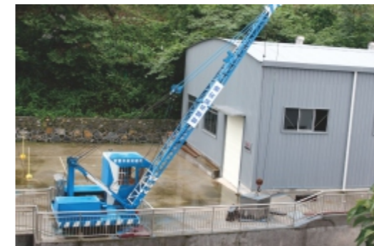
用于吊装实验的起重实验机 Hoisting Experiment Crane
